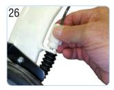
Regulieren Sie die Bremse gegebenenfalls anhand der Kabelverstellschraube. Kann die Bremse nicht so eingestellt werden, dass sie das Rad abbremst, lösen Sie die Kabelbefestigung und bringen Sie sie in die benötigte Position.
