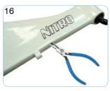
Fassen Sie den Bremszug mit einer langen, dünnen Spitzzange durch das Kabelloch und ziehen Sie ihn aus dem Rahmen heraus.
