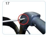
Befestigen Sie den Handgriffhalter wieder am Rahmen. Die größte der drei Schrauben wird in das mittlere Loch gedreht.
