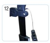
Drehen Sie die Schraube, die den Bremsgriff an der Griffstange befestigt, mit Hilfe eines Kreuzschlitzschraubendrehers heraus. Nehmen Sie den Bremsgriff ab.
