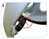
Lösen Sie die Kabelbefestigung mit einem 4 mm Inbusschlüssel und nehmen Sie sie ab.
