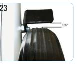
Schieben Sie die Kabelbefestigung auf den Bremszug bis zwischen Bremsbacke und Rad ein Abstand von etwa 3 mm entsteht.
