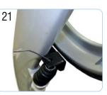
Schieben Sie den Bremszug durch die Kabelbefestigung und die Feder.
