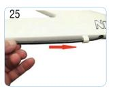
Schieben Sie überschüssiges Bremszugkabel in das Loch unten im Rahmen.
