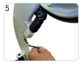
Ziehen Sie den Bremszug aus der Kabelverstellschraube und der Feder heraus.
