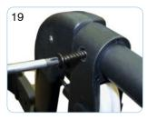
Schieben Sie den Bremsgriff auf den Griffhalter. Während Sie die Bremse weiter schieben, ziehen Sie am Bremszug, der unten aus dem Rahmen kommt. Schrauben Sie den Bremsgriff fest.
