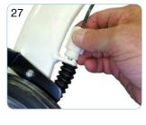
Regulieren Sie die Bremse gegebenenfalls anhand der Kabelverstellschraube. Kann die Bremse nicht so eingestellt werden, dass sie das Rad abbremst, lösen Sie die Kabelbefestigung und bringen Sie sie in die benötigte Position.
