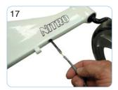
Ziehen Sie an der Schnur, bis der Bremszug durch das Loch unten am Rahmen kommt.
