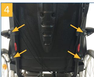
Pour régler la hauteur du dossier, desserrez les 4 vis à six pans creux des clameaux de fixation et déplacez le dossier jusqu'à la hauteur souhaitée puis resserrez les vis.
