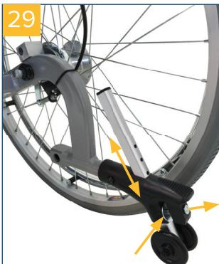
Die Antikipräder verhindern ein Umkippen des Rollstuhls nach hinten. Zusätzlich dienen Sie zur Erleichterung des Ankippens durch eine Begleitperson. Die Räder können in der Höhe verstellt werden. Ziehen Sie die silberfarbenen Scheiben zu sich heran und schieben Sie das Rohr entlang der Halterung nach oben bzw. unten.
