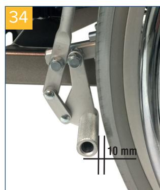
La distanza tra il perno del freno e il copertone non deve essere superiore a 10 mm nel punto più stretto con il meccanismo frenante aperto al massimo. Per regolare o correggere questa distanza, svitare le due viti sul listello per la regolazione del freno di stazionamento. Spostare i freni nella posizione corretta.
