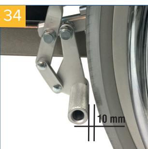
La distance entre les boulons de frein et le flanc du pneu doit être de 10 mm au point le plus étroit, le mécanisme de frein étant ouvert au maximum.
