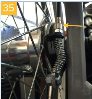
Per ottenere un effetto frenante ottimale, regolare la forza frenante per mezzo dell'apposita vite di regolazione. La forza frenante aumenta svitando la vite di regolazione.
