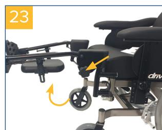
Pour relever le repose-jambe, desserrez la vis à poignée en étoile et amenez les repose-jambe à la position souhaitée. Resserrez ensuite la vis à poignée en étoile (fi g. 23).
