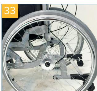
Voordat u de aandrijfwielren verwijdert, moet u de rolstoel beveiligen tegen omvallen. Druk op de zwarte knop op de steekas om de verbinding los te maken.
