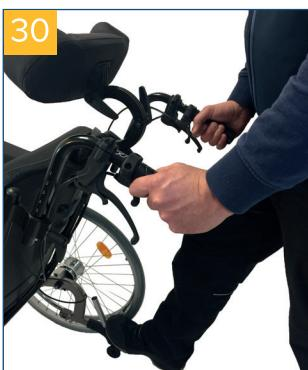
Die Ankipp hilfen ermöglichen es dem Begleiter, den Rollstuhl leichter anzukippen und so leichter über Hindernisse zu bewegen. Schieben Sie zunächst die Antikipräder in die höchste Position. Treten Sie mit dem Fuß auf den Hebel und halten Sie das Gleichgewicht mit dem Schiebegriff.
