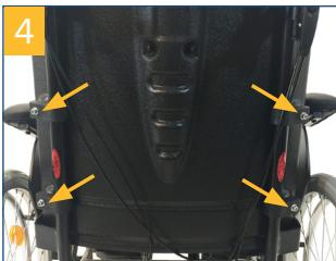
Zur Einstellung der Rückenlehnenhöhe lösen Sie die 4 Inbusschrauben der Halteklemmen und verschieben die Rückenlehne in die gewünschte Position, Schrauben wieder festziehen.
