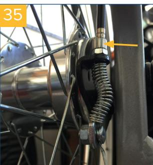
Pour obtenir un freinage optimal, ajustez la force de freinage au moyen de la vis de réglage. Pour augmenter la force de freinage, desserrez la vis.
