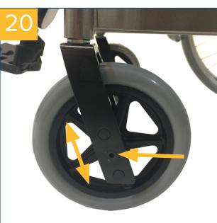
Die Höhe der Lenkräder kann in drei Stufen verändert werden. **Kippgefahr!** Durch Verstellen der Höhe der Lenkräder erhöht sich unter Umständen die Kippgefahr nach vorne. Entfernen Sie die Verschraubung der Radachse und ziehen Sie diese heraus. Befestigen Sie das Rad in der gewünschten Höhe und ziehen Sie die Verschraubung wieder an.
