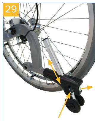
Le ruote antiribaltamento impediscono alla carrozzella di ribaltarsi all'indietro. Inoltre servono a facilitare l'inclinazione della carrozzella da parte dell'accompagnatore. L'altezza delle ruote è regolabile. Tirare verso di sé il disco color argento e spingere il tubo lungo il supporto verso l'alto o verso il basso.
