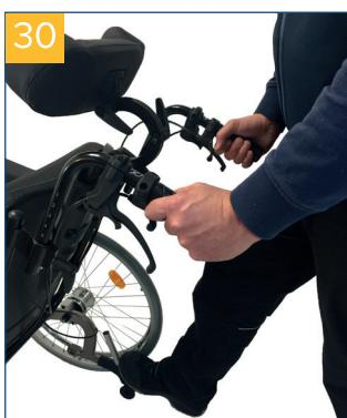
Les aides au basculement permettent à l'auxiliaire de basculer plus facilement le fauteuil roulant pour franchir des obstacles. Poussez pour commencer les roues anti-basculement dans la position la plus haute. Appuyez sur le levier avec le pied et maintenez l'équilibre au moyen de la poignée de poussée.
