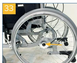
Prima di rimuovere le ruote di spinta, assicurare la carrozzella contro il ribaltamento. Premere il pulsante nero sull'asse della ruota per aprire il collegamento. Quindi rimuovere la ruota.
