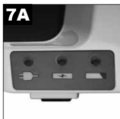
7A 7314P - Vælg den ønskede strømkilde. (Spring trin 8 over ved brug af det indvendige batteri.)
